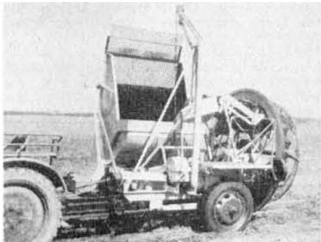
Kartoffelerntemaschine „HKS“ mit Vorratsbunker der Firma Holstein und Lührs, Otterstedt
