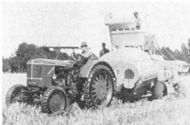
45 PS Deutz-Dieselschlepper mit unabhängiger Zapfwelle beim Antrieb eines Claas-Mähdreschers „Super“
